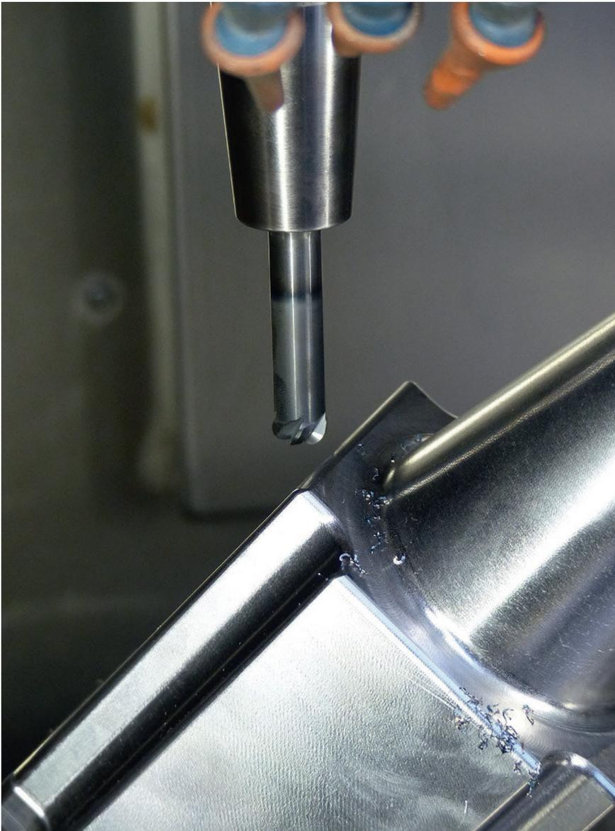
1 Beim Anwender Wisoma spielte der Torusfräser WXS-CRE von OSG nach 15 Stunden Weichbearbeitung beim Schlichten eines Teils aus 1.2379 mit 60 HRC seine Vorteile aus
