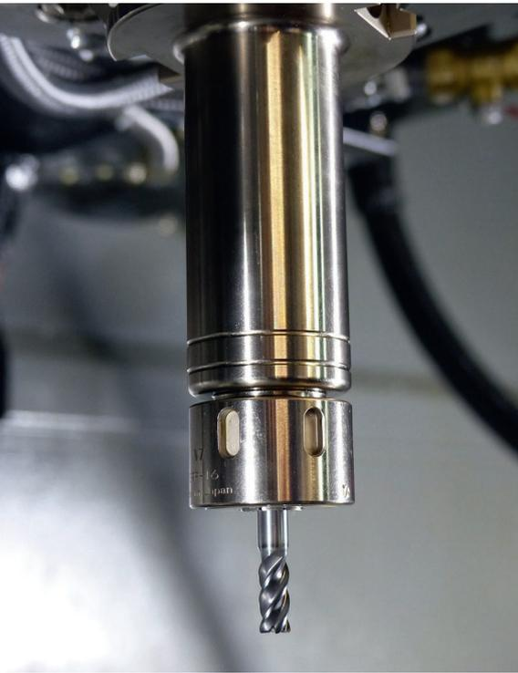
3 Dem Anwender HSM empfiehlt OSG den Vollhartmetallfräser AE-VMS (hier auf der Maschine), musste doch einer extremen Belastung an der Schneidkante entgegenwirken © OSG
